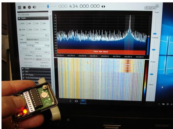
Test eines Garagentoröffners 433MHz SDR
